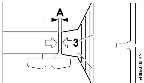
Als deze hier correct is ingeschoven moet het beschermrooster (3) gelijkliggen met de koppelingsmof (spleet A maximaal 5 mm).
