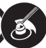
Przedmioty mogą zostać wyrzucone lub odbite we wszystkich kierunkach. W celu zminimalizowania ryzyka obrażeń u użytkownika spowodowanych wyrzuconymi przedmiotami nigdy nie należy używać kosi mechanicznej bez prawidłowo skonfigurowanego i zamontowanego zabezpieczenia. Zachować odstęp do co najmniej 15 m (50 ft) od innych osób.
