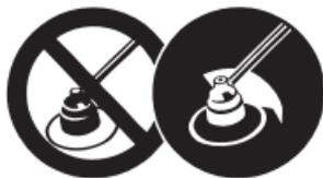
Os objetos podem ser projetados ou saltar em todas as direções. Para reduzir o risco de ferimento do utilizador por objetos projetados, nunca usar uma motorroçadora sem uma proteção devidamente configurada e corretamente montada. Manter uma distância dos transeuntes de, pelo menos, 15 m (50 ft).
