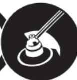
Des objets peuvent être projetés dans tous les sens et ricocher. Afin de réduire le risque de blessures de l'utilisateur par des objets projetés, il ne faut jamais utiliser une débroussailleuse sans capot protecteur correctement configuré et correctement monté. Veiller à ce que les personnes qui pourraient se trouver dans le voisinage restent à une distance d'au moins 15 m (50 pi).
