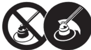
物件可能朝所有方向飞出或弹出。为降低飞出物件造成用户受伤的风险，严禁使用未正确配置与正确加装防护罩的割灌机。与旁观者保持至少 15 m ( 50 英尺 ) 的距离。
