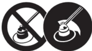
Föremål kan slungas iväg i alla riktningar eller studsas. För att minska risken för att användaren skadas av ivägslungade föremål får du aldrig använda en motorlie utan korrekt konfigurerat och korrekt installerat skydd. Åskådare ska stå på minst 15 m (50 ft.) avstånd.
