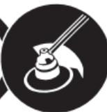
Obiectele pot fi aruncate sau pot ricoșa în toate direcțiile. Pentru reducerea riscului de vătămare a utilizatorului cu obiectele aruncate, nu folosiți niciodată o motocoasă fără un dispozitiv de protecție configurat și montat corect. Țineți persoanele din jur la o distanță de minimum 15 m (50 ft.).
