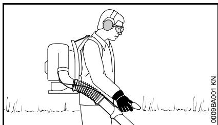
L'apparecchiatura è portata sulla schiena. La mano destra sull'impugnatura di comando guida il tubo soffiatore.
