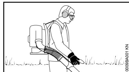
La machine se porte sur le dos. La main droite tient la poignée de commande et guide ainsi le tube de soufflage.
