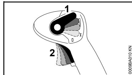
Der Gashebel (2) kann durch Betätigung des Stellhebels (1) stufenlos arretiert werden:
