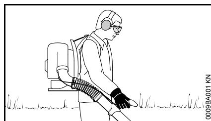
Het apparaat wordt op de rug gedragen. De rechterhand bedient de blaaspip via de bedieningshandgreep.
