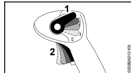
De gashandel (2) kan traploos worden gearresteerd met behulp van de stelknop (1):
